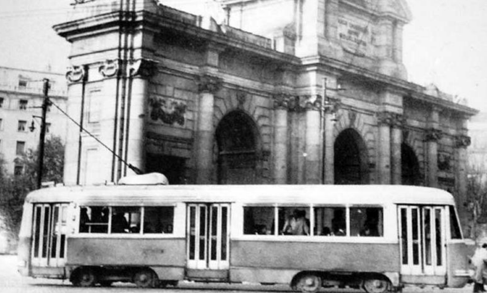
Línea 4 a su paso por la plaza de la Independencia. El tranvía es un FIAT de la serie 1000, modelo recibido en la década de 1940 y con el que la EMT cerró sus últimas líneas en el año 1972. En Italia hay algunos que siguen funcionando, compartiendo vía con unidades modernas (Fuente: http://historias-matritenses.blogspot.com.es )
