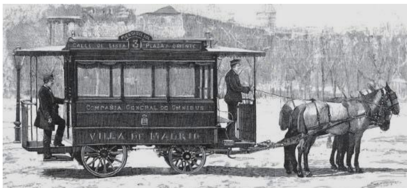
Ejemplo de un ómnibus de la línea Plaza de Oriente-Lista. Estos vehículos circulaban sobre el pavimento normal de las calles, pero los últimos diseños, caso del de este grabado, tenían unas carrocerías casi idénticas a las de los tranvías que circulaban por carriles. (Fuente: memoriademadrid.es)
