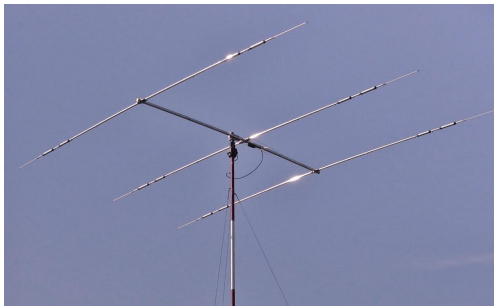
Antena Yagi para Onda Corta (izquierda) y dos modelos de rotores, antiguo (arriba) y moderno (derecha). Imágenes: publicidad de la firma Yaesu Musen y colección del autor.
